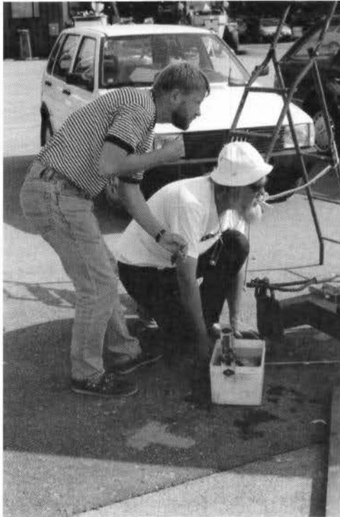
Mittamerkkien paikat siirretään maahan tasolle käyttäen apuna luotilankaa vesiasistassa.
